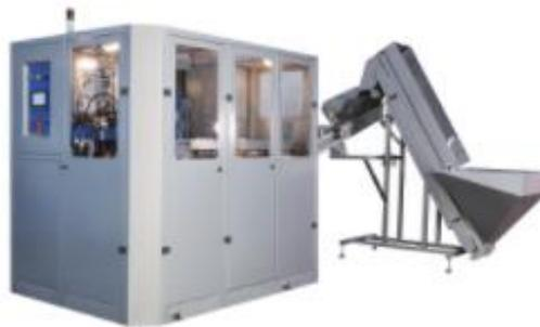
Автомат А-1000-М2Э предназначается для производства ПЭТ – бутылок из разогретых преформ методом вытяжки и двухстадийного выдува в двухместной пресс-форме. На оборудовании можно изготовить бутылки емкостью от 0,25 до 1,5 литров, производительностью 1200 бутылок в час.
