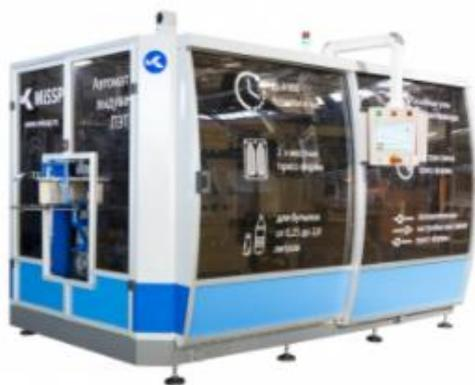
Автомат А-4000-2 предназначается для производства ПЭТ – бутылок из разогретых преформ методом вытяжки и двухстадийного выдува в двухместной пресс-форме. На оборудовании можно изготовить бутылки емкостью от 0,25 до 2,0 литров, производительностью 4000 бутылок в час.
