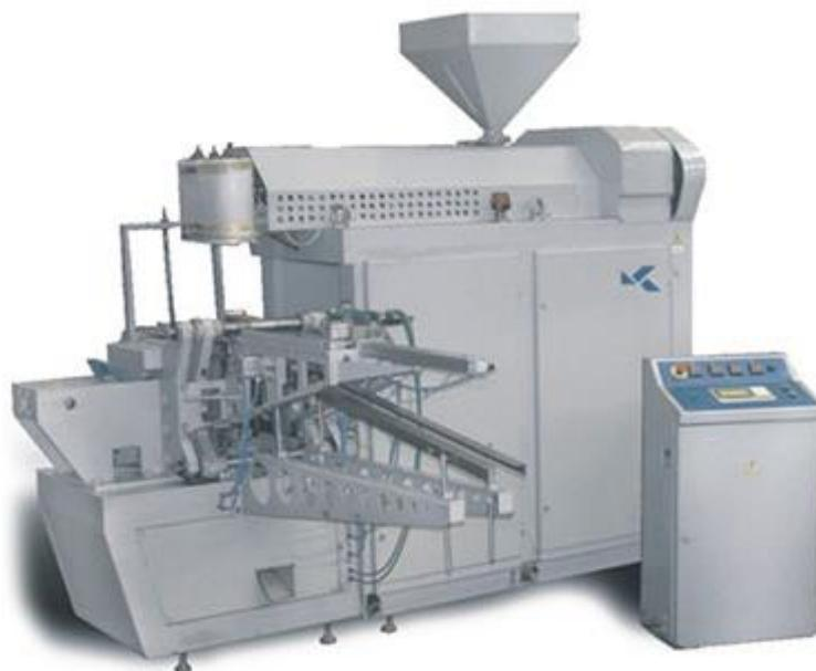
Автомат предназначен для изготовления полимерных емкостей от 0,25 до 1 литра, методом раздува.
