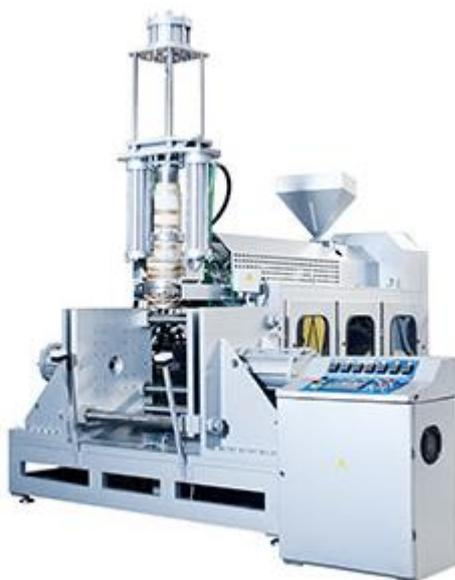
Установка предназначена для изготовления тонкостенных полых изделий различной формы из термопластичных материалов методом экструзии с раздувом.
