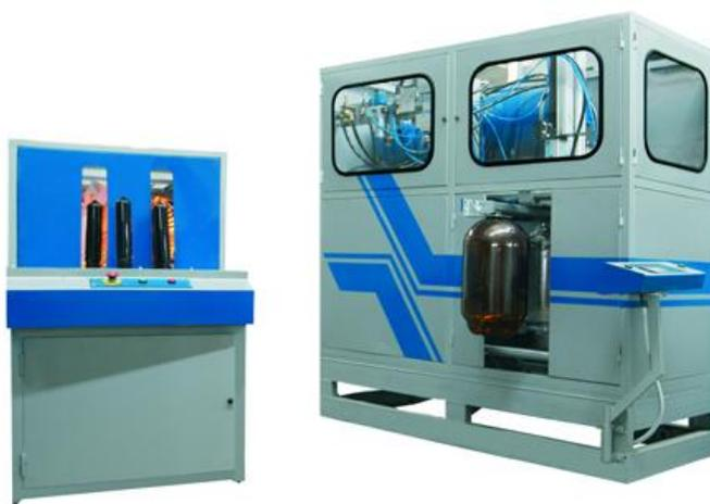
Полуавтомат ПВ-19-40 - предназначен для производства ПЭТ-кег из разогретых преформ методом вытяжки и раздува в одноместной пресс-форме. Полуавтомат производит ПЭТ-кеги емкостью 10.0 - 40.0 литра, а так же 19 литровые (кулерные) бутылки. Получаемая кега, благодаря полной герметичности, прочности и удобства, используется для розлива пива, кваса, и других жидкостей.
