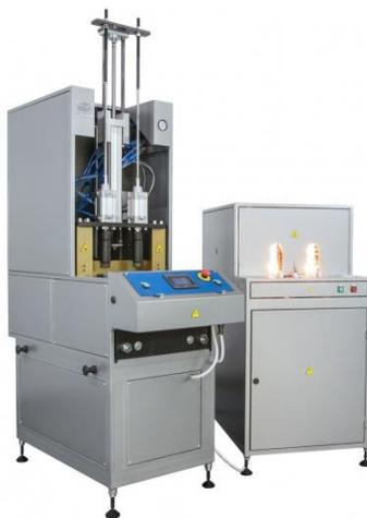
Оборудование предназначается для производства бутылок из разогретых ПЭТ преформ методом растягивания и двухстадийного выдува в двухместной пресс-форме. На оборудовании можно изготовить бутылки объемом до 5,0 литров для розлива газированных и спокойных жидкостей.
